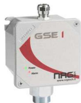
Датчик газа серии GSE1 разработан и изготовлен в соответствии с европейскими стандартами для обнаружения повышенных концентраций метана и сжиженного нефтяного газа (LPG). Имеют аналоговый выход 4-20 мА. Встроенный микропроцессор обеспечивает гарантированное определение горючих газов и передачи сигнала на блок управления. Датчик GSE1 работает в комплексе с блоком управления серии GCU104. Область применения сигнализатора GSE1 котельные, производственные помещения, административный и жилой сектор.
