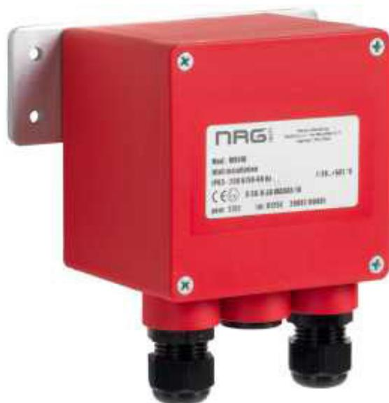
Устройство, которое в сочетании с электромагнитным клапаном перекрывает подачу газа в связи с сейсмическим событием (с анализом времени и частоты на ускорение 3-х осей) и для дистанционного контроля. Датчик может быть установлен с клапанами нормально закрытого и нормально открытого исполнения с ручным взводом. Можно применять сейсмические датчики с уже установленными электромагнитными клапанами, а так же другими устройствами безопасности.
