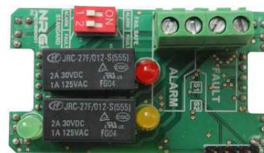
Плата расширения PEC02 - это устройство, подключаемое к датчикам газа NRG Tech S.r.l. которое обеспечивает получение двух выходных контактов реле свободных от напряжения. Совместимо с газовыми датчиками, BMS и другими устройствами которым требуется дискретный выход. Оба реле могут работать как нормально открытые так и нормально закрытые. Выбор рабочих условий реле осуществляется DIP переключателями.
