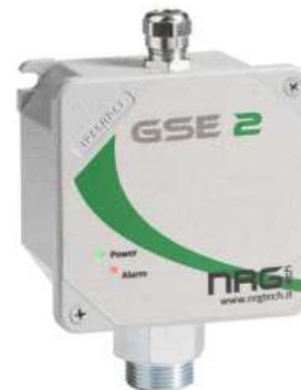
Датчик газа серии GSE2 разработан и изготовлен в соответствии с европейскими стандартами для обнаружения повышенных концентраций горючих и токсичных газов. Имеют аналоговый выход 4-20 мА. Встроенный микропроцессор обеспечивает гарантированное определение горючих и токсичных газов и передачи сигнала на блок управления. Датчик GSE2 работает в комплексе с блоком управления серии GCU104. Область применения сигнализатора GSE2 котельные, производственные помещения, административный и жилой сектор.
